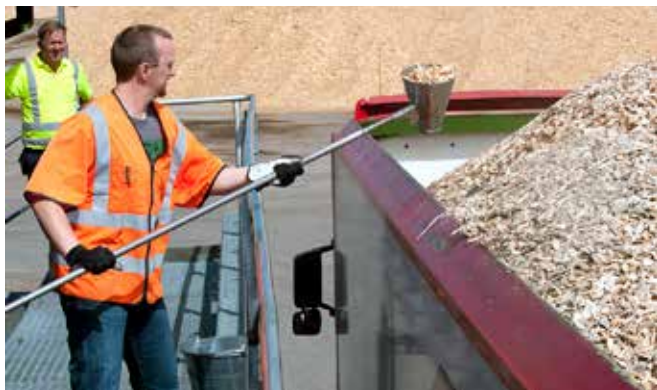
Manuell provtagning ur skäppa. Vid provtagning ska en för materialstorleken anpassad spade, skopa eller sond användas.
