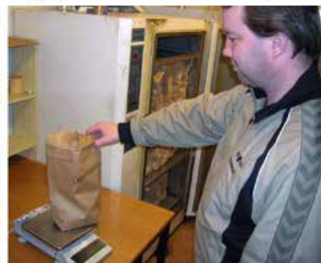
Vid Jämkraft i Östersund tillämpas stickprovssystem för att bestämma torrhalten på grot. För alla leveranser bedöms torrhalten. Detta görs med hjälp av foton. Slumpmässigt valda travar/skäppor flisas varefter torrhaltsprov tas ur flisen.
