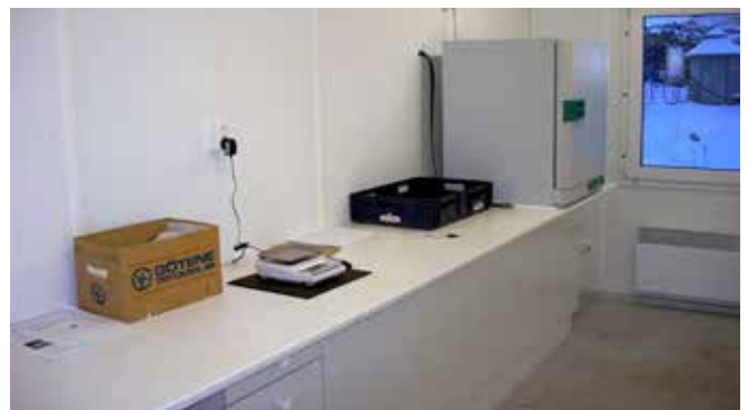
Mobilt torrhaltslab vid SEBABs terminal i Mora. Innehåller analysvåg och torkskåp.
