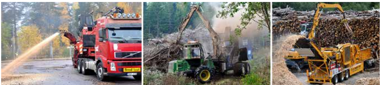
Skivhugg på terminal till vänster, skotarmonterad trumhugg på ett grotavlägg i mitten samt en kross som sönderdelar bränsleved på terminal.
