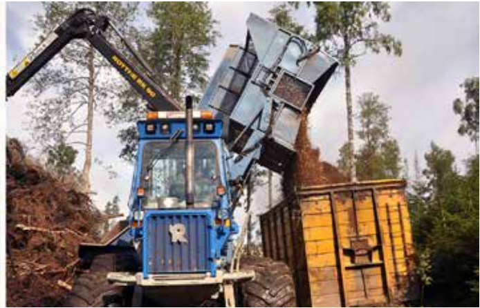
Skopplastning, eller tippning från en skäppa till en annan, innebär en omrörning som minskar torrhaltsvariationen.
