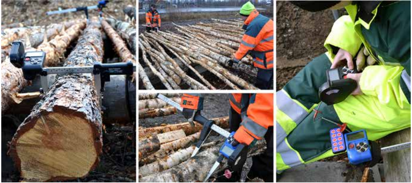
Stockmätning av kontrolltravar (eller stickprovstravar) kan utföras med dataklavar.
