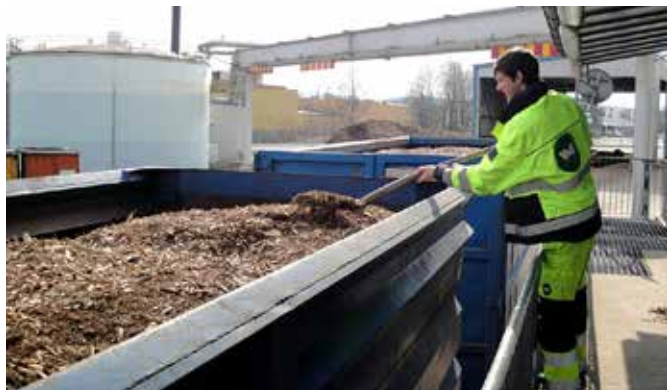
Manuell provtagning ur skäppa. Vid provtagning ska en för materialstorleken anpassad spade, skopa eller sond användas.
