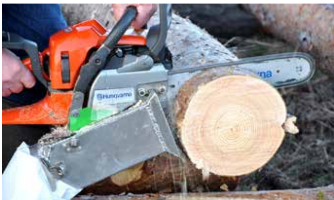
Motorsåg med spånsamlare (till vänster). Torrhaltsprovtagning vid Swedespan i Hultsfred (till höger)
