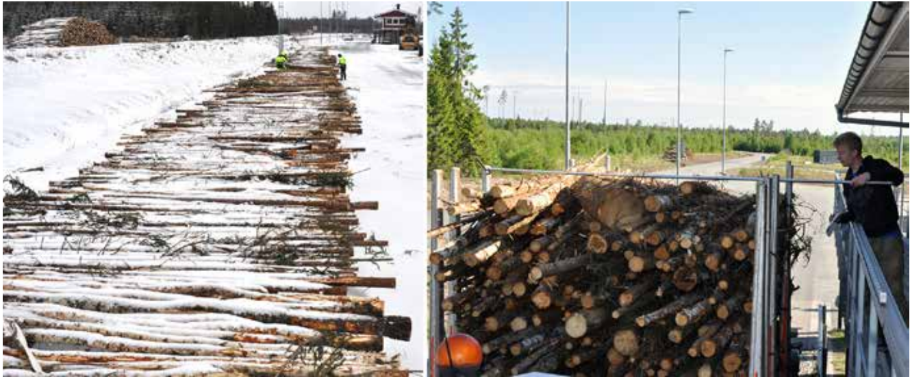
Vid travmätning av träddelar (delkvistad energived) blir vedvolymbedömningen svår. Stockmätning för kontroll kan vara mycket tidsödande. Trave med 867 stockar. Foto från SLU:s studie i Stockaryd.
