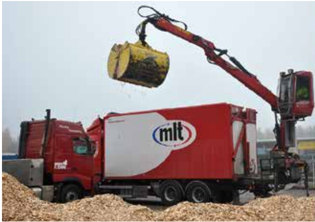
Skopplastning, eller tippning från en skäppa till en annan, innebär en omrörning som minskar torrhaltsvariationen.
