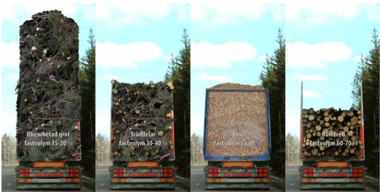
Lassen innehåller lika mycket biomassa. Fastvolymmätning lämplig endast för rundveden. (Efter Falk, S.)
