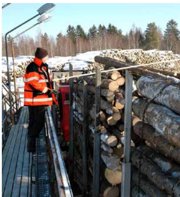
Mätning av trave på fordon. TL = travlängd (TL1 = övre bankbredd, TL2 = nedre bankbredd), SL = stocklängd, H = traves höjd
