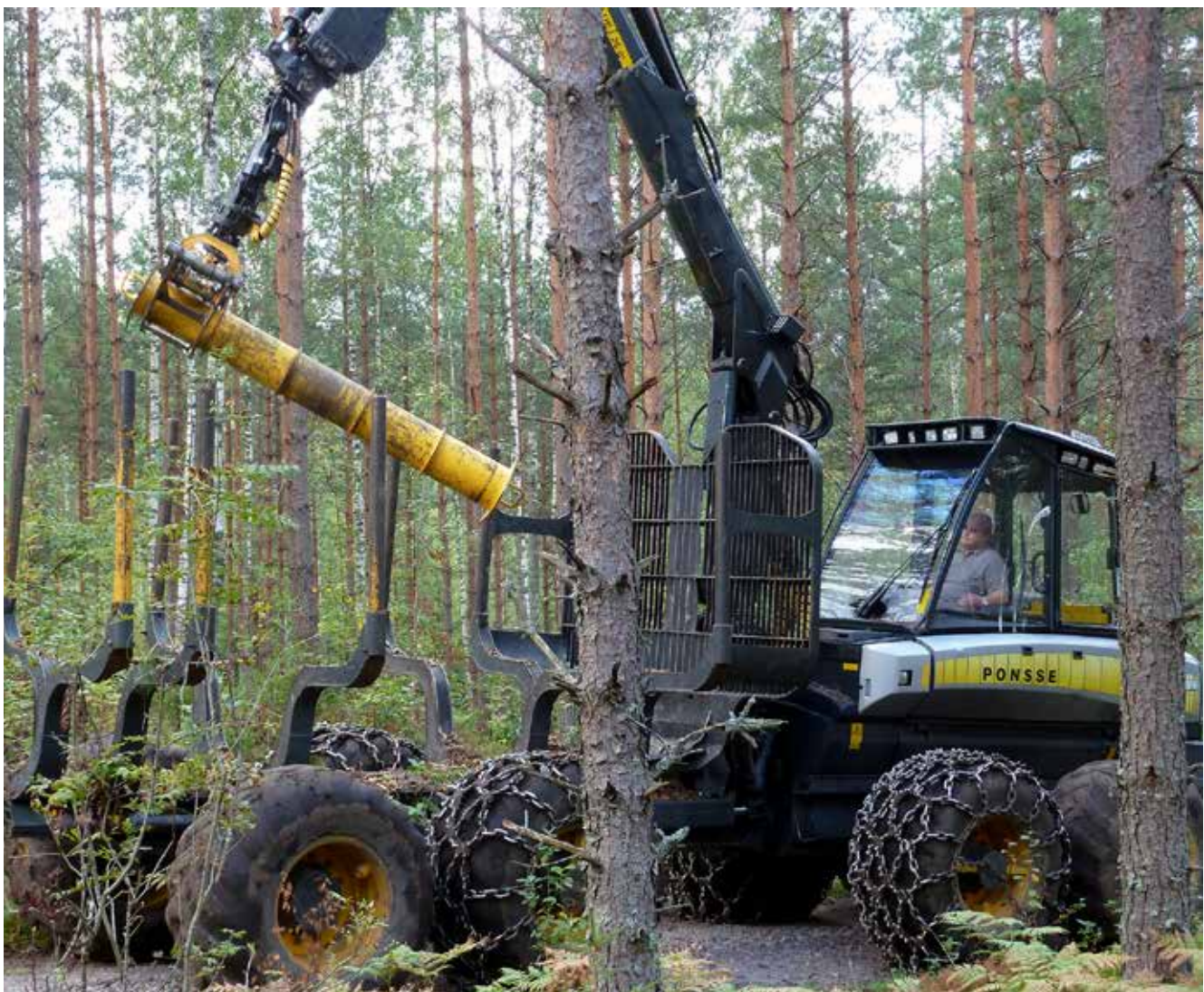
Finsk kontroll av kran-spetsvåg på skotare. Skotarföraren väger provkroppen varje dag enligt fastställt förfarande.
