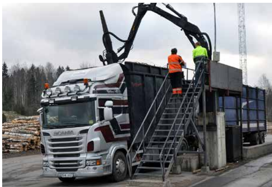
Borr för torrhaltsprovtagning vid Frövifors mätstation. Används på grot och träddelar/småträd.
