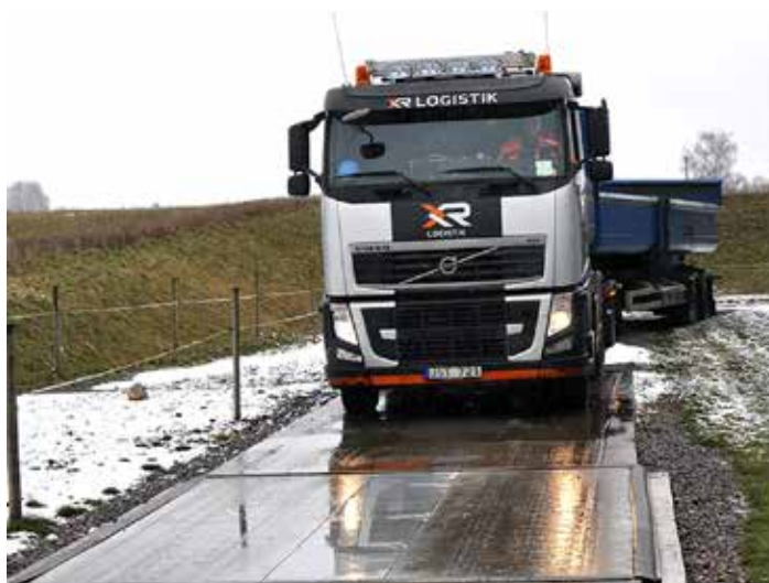
Dynamisk fordonsvåg (axelvåg), Viktorvåg till vänster, Wånelidvåg till höger.
