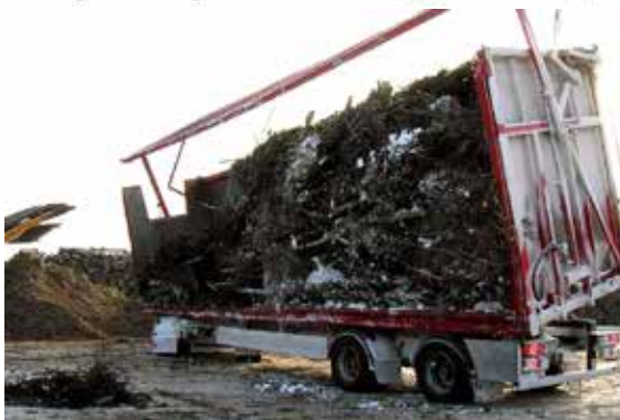
Vid Jämkraft i Östersund tillämpas stickprovssystem för att bestämma torrhalten på grot. För alla leveranser bedöms torrhalten. Detta görs med hjälp av foton. Slumpmässigt valda travar/skäppor flisas varefter torrhaltsprov tas ur flisen.
