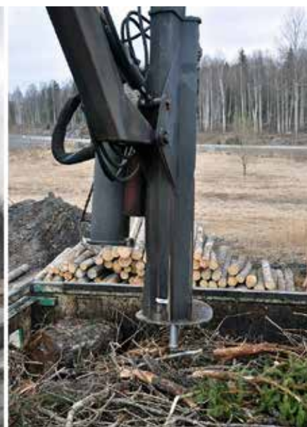
Borr för torrhaltsprovtagning vid Frövifors mätstation. Används på grot och träddelar/småträd.
