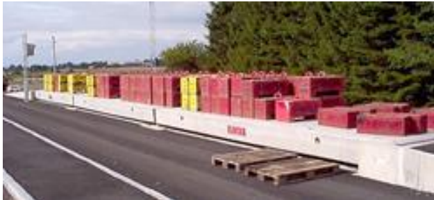
Figur 2. Kalibrering av 24-m statisk fordonsvåg (Flintab).
