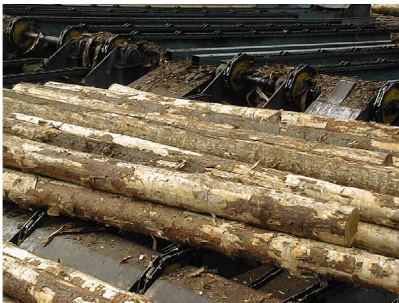
Bild 2. Provstockarna vid repeterbarhetstestet efter sista körningen
