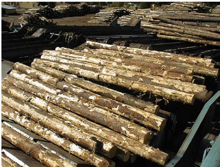
Bild 1. Provstockarna vid repeterbarhetstestet efter första körningen
