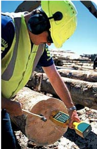
Figur 2. Industriell mätning av stockars egenfrekvens vid ett sågverk på Nya Zeeland.
