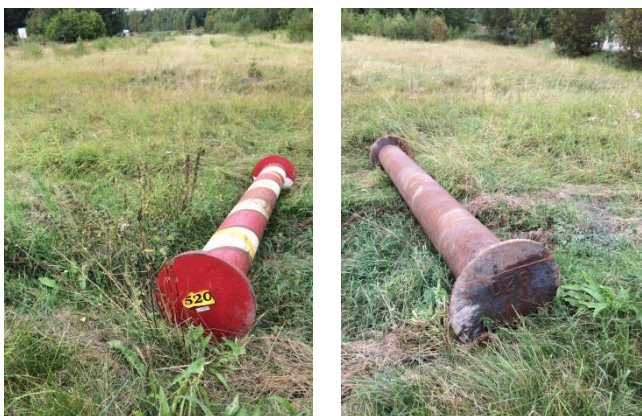
Figur 1. De två kontrollvikterna som användes i studien. Den vänstra, röd-vita vikten väger 520 kg och den högra vikten väger 920 kg.
