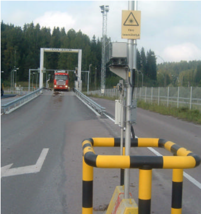
Figur 11. Modus 2000. Bilens hastighet mäts med laser från ca 40 m avstånd. Via ljussignaler får föraren information om att mätning pågår och att han håller rätt hastighet.
