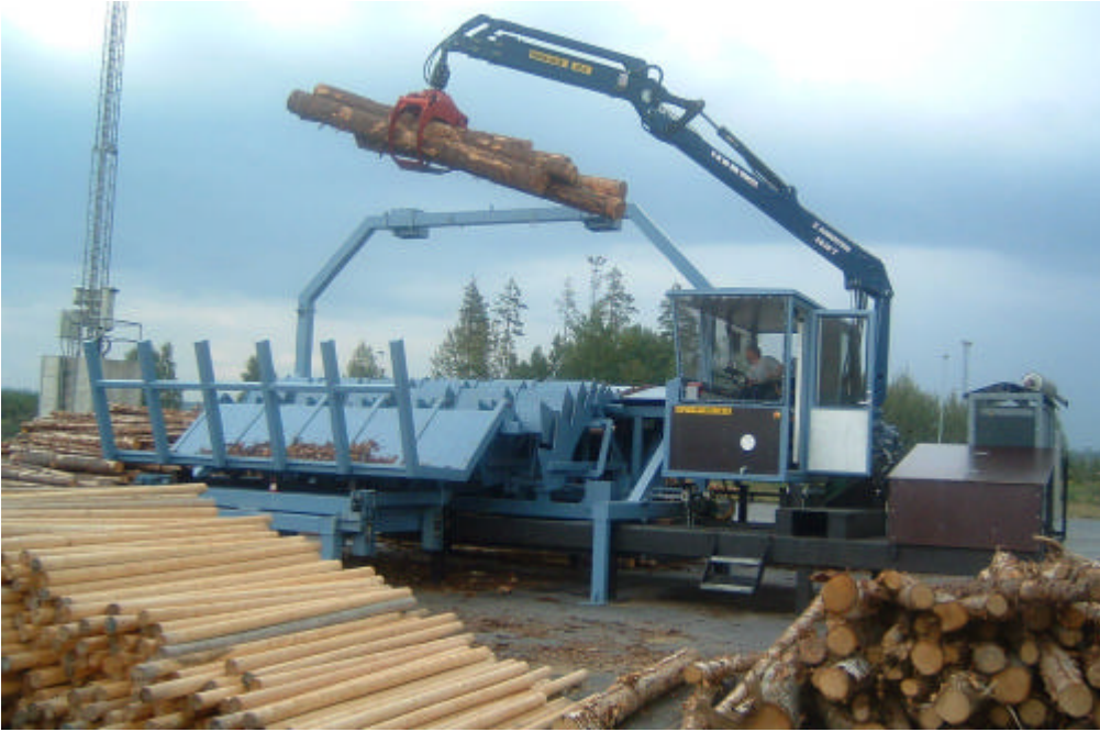
Figur 8. Modus 1000. Kranen som monterats bakom mäthuset når båda sidor av anläggningen för ilastning och undanläggning av virke.
