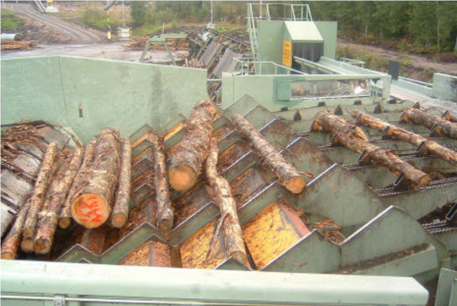
Figur 5. Sunila, vy från virkesmätare/operatör mot stegmatare och bedömningsbord. I bakgrunden mätram och sorteringsbana. Notera virkets diameterspridning och krokighet.
