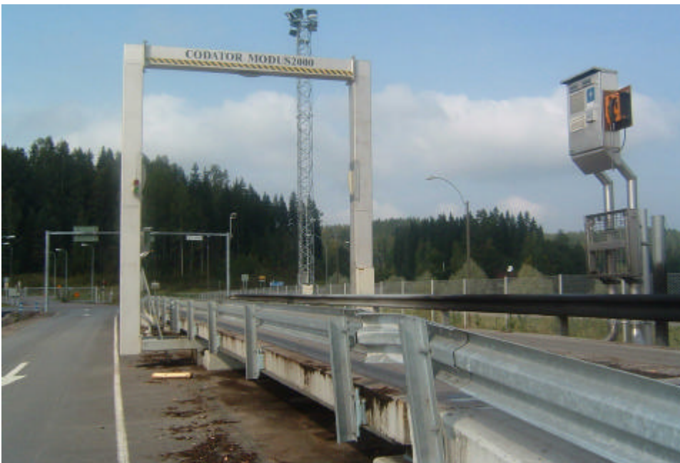
Figur 10. Modus 2000. Laserportal och förarterminal är placerade på en fordonsvåg. Att bilen stannar för registrering under pågående lasermätning påverkar ej resultatet.
