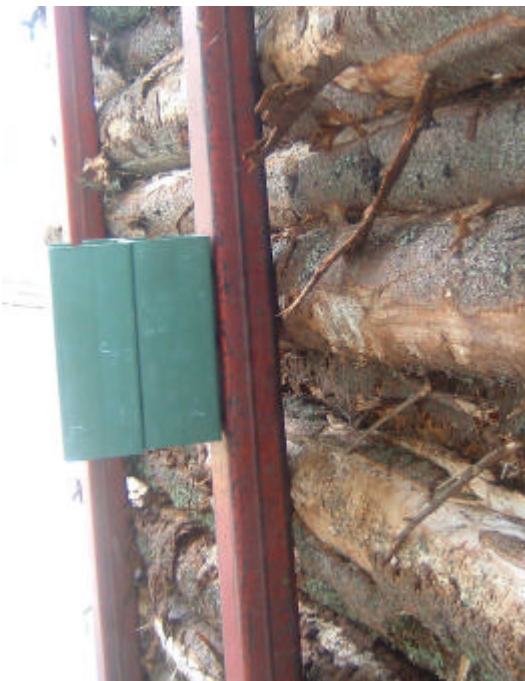
Figur 12. Deltraveavskiljare fäst med magnet.
