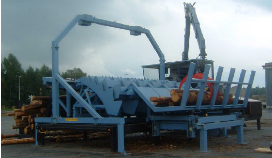
Figur 6. Modus 1000. Stockarna vägs i stockfickan varefter de tippas över på stegmataren. I mätportalen sitter två laserskannrar.
